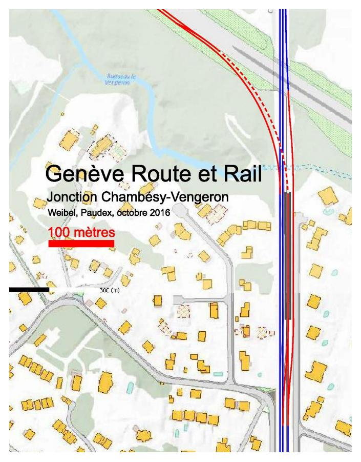
Il en va de même de la jonction de Chambésy-Vengeron. Sa réalisation passe par le ripage vers l'est de la voie régionale, de manière à aménager l'espace nécessaire à la trémie. La bretelle souterraine est utilisée dans les deux sens.
