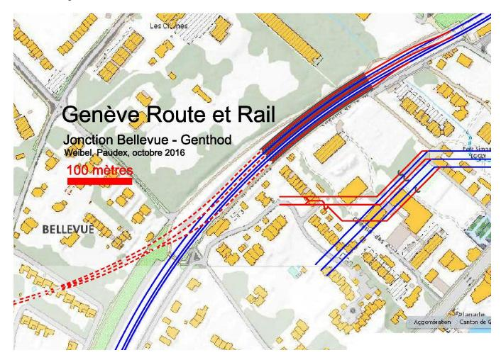
C'est la jonction la plus complexe. Trois trémies correspondent aux trois voies de la ligne actuelle entre Coppet et Cornavin, en général exploitées ainsi : la voie côté Lac réservée au trafic régional, dans les deux sens, les deux voies côté Jura réservées au trafic rapide, une par sens.
