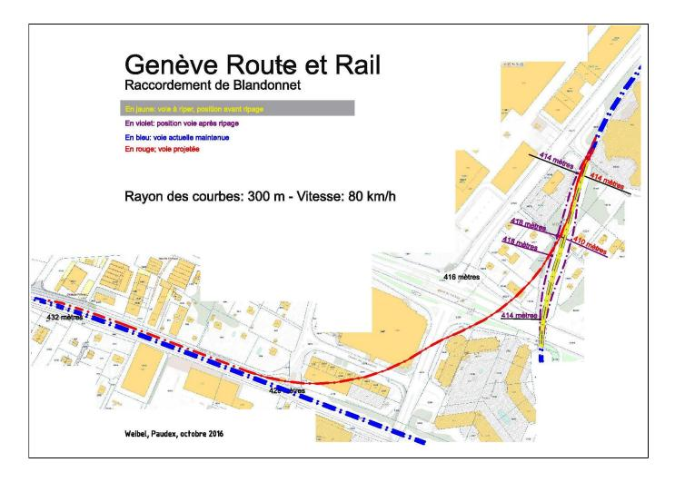
Il est évidemment hautement souhaitable que le raccordement de Blandonnet, qui permettra de relier la ligne de La Plaine à l'Aéroport ne « cisaille » aucune des deux voies qui desservent l'Aéroport.
